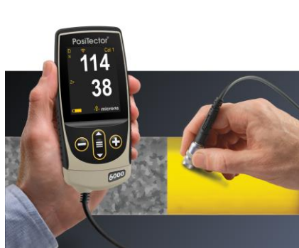
鋅與漆的膜厚同時量測顯示
